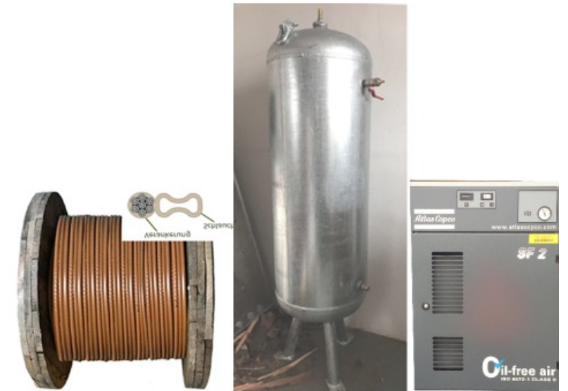
Anlage bestehend aus linearem Belüftungssystem, Druckluftbehälter, Kompressor und Kleinteilen
