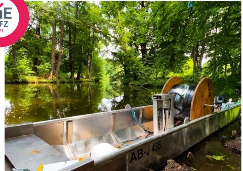
Drausy® Professional ist ein speziell geformter PUR-Schlauch mit **Druckkompensation**: bis 10.000 m Länge, bis 100 Tiefe. Das Lineare System wird vom Boot aus über den Wasserweg auf den Grund abgelassen.
