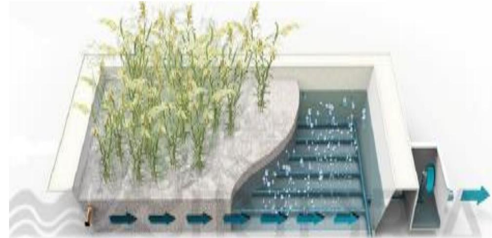
Schema eines gleichmäßig belüfteten Pflanzenbiotops – als letzte Reinigungsstufe. Die Rhizome werden belüftet – teils können Pflanzen bestimmte Stoffe binden (z.B. Metalle)
